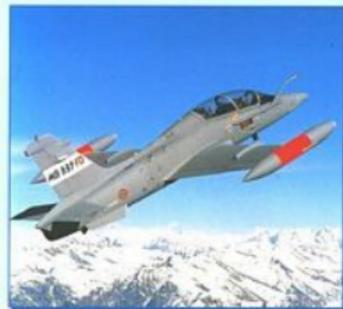
Un MB339 FD con capacità di rifornimento in volo.
